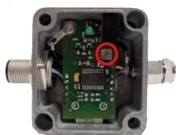
Abb. 6: CON.USB.WT Position von POW Schalter
